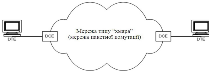
Рис. 1. Структурна схема мережі Frame Relay [4]
