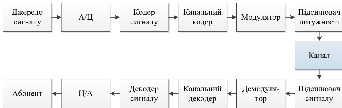
Рис. 1. Блок-схема типової цифрової системи зв'язку
