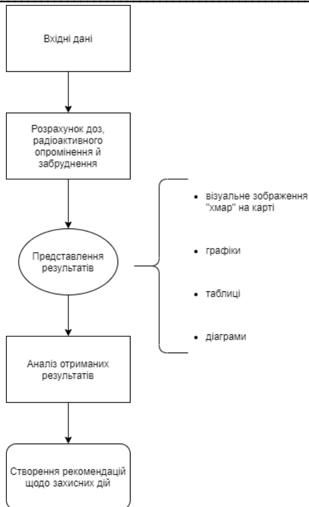
Рис. 3. Схема роботи систем в області радіаційного моніторингу.
