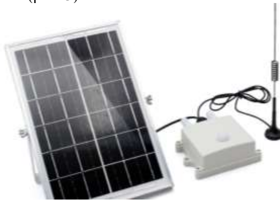
Рис. 3. Багатофункціональний сенсор NB-IoT (температура / вологість / освітлення / CO 2 )
