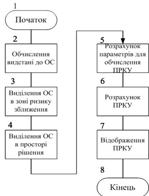
Рис. 1. Схема алгоритму розрахунку ПРКУ
