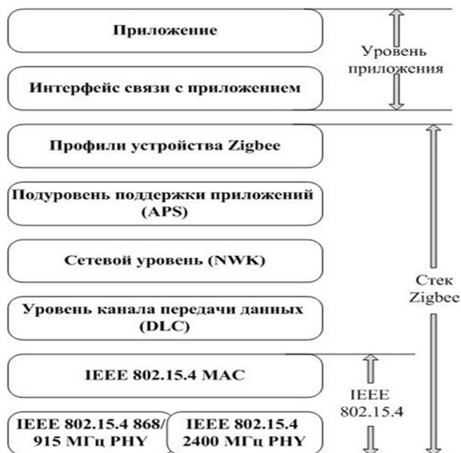
Рис. 3. Стек сетевых уровней Zigbee
