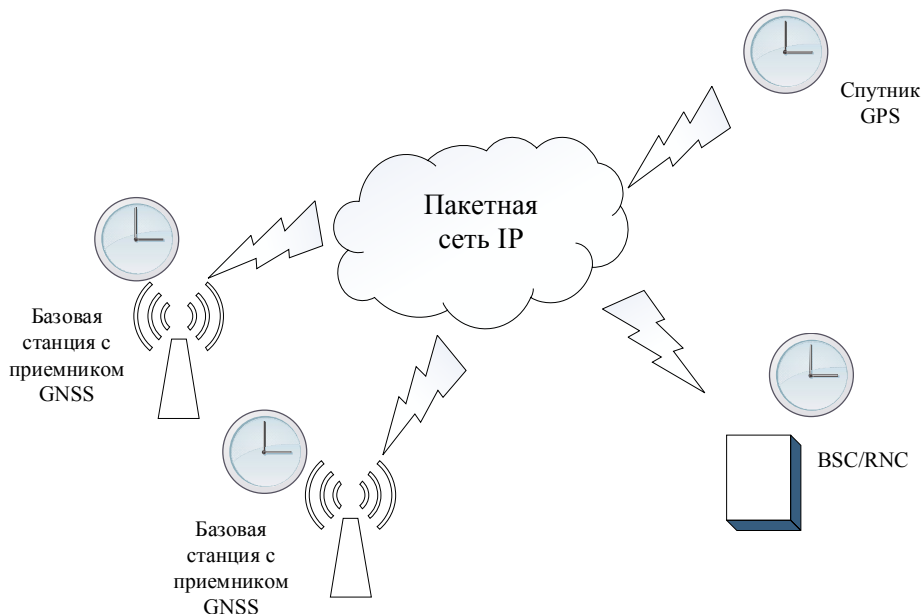
Рис .1. Типовая схема синхронизации с использованием GNSS
