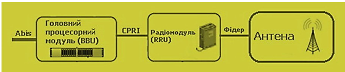
Рис. 1 Типова архітектура базової станції
